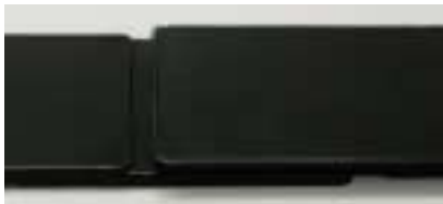
(c) レーザ透過 PP 樹脂 (黒) と レーザ吸収 PP (黒) の溶着事例 レーザ出力 20 W、ビーム操作速度 20 mm / s 溶着幅 : 2 mm
