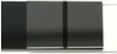
(a) アクリル樹脂 (透明) と ABS 樹脂 (黒) の溶着事例 レーザ出力 20 W、ビーム操作速度 100 mm / s 溶着幅 : 2 mm
