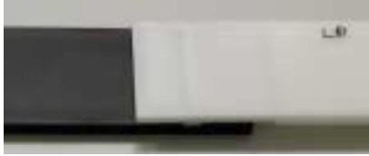
(b) ポリプロピレン (PP) 樹脂 (白) と (黒) の溶着事例 レーザ出力 20 W、ビーム操作速度 15 mm / s 溶着幅 : 2 mm
